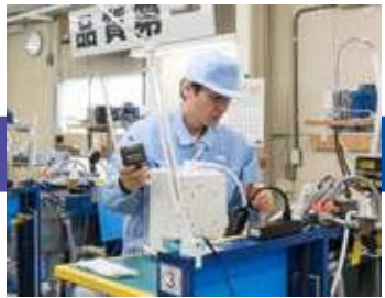
La prueba de pH también se realiza durante la prueba de flujo de agua en la línea de terminación.
